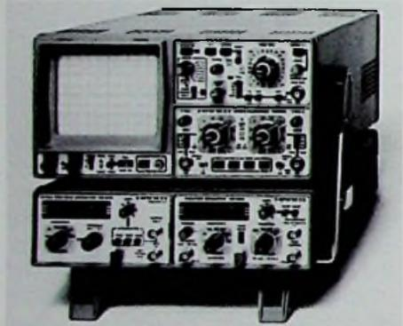
**Bild 7:** Mit dem Modul-System 8000 läßt sich ein Kompaktmeßplatz rund um das Oszilloskop aufbauen (Hameg-Pressbild)
