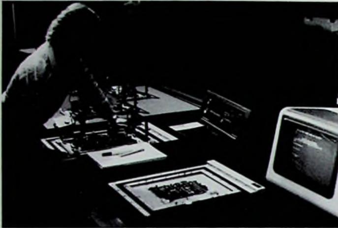
**Bild 1:** 60 000 Testschritte in 25 Sekunden, das ist die atemberaubende Stück-Leistung dieses In-Circuit-Testers (ITT-Pressbild)
