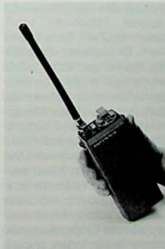
**Bild 1: UKW-Handsprechfunkgerät für den Seefunk** (Dantronik-Pressbild)
