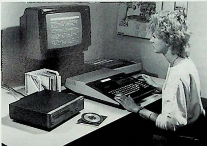
Bild 1: CD-ROM mit 600 Mbit Speicherkapazität (Philips-Pressebild)
